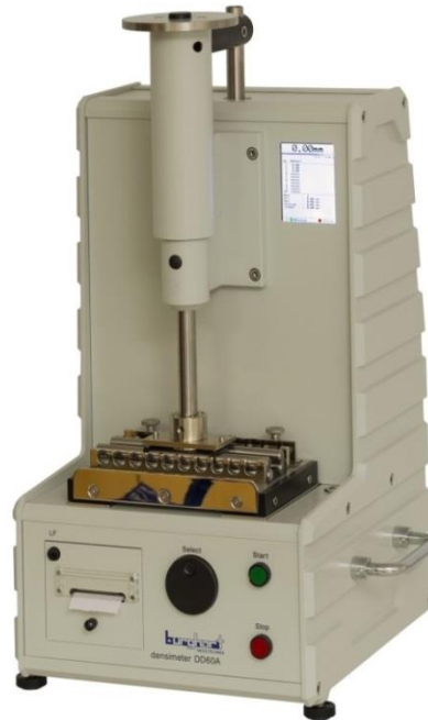
DD60A zur Härtemessung von Zigaretten oder Filterstäben
