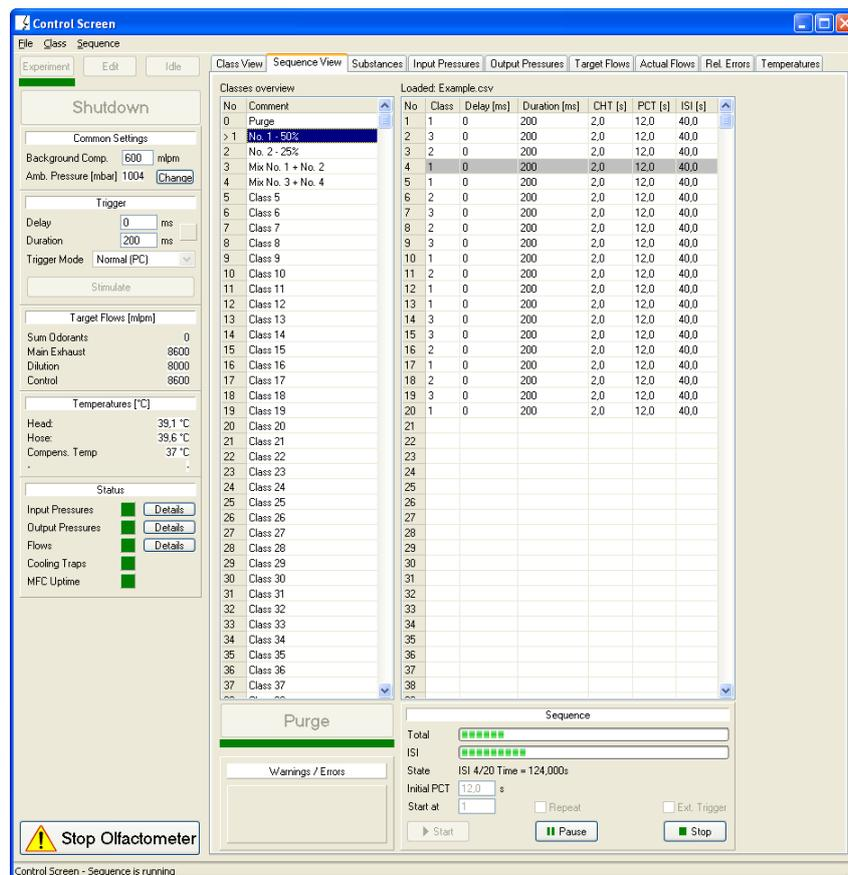
Die Steuerungssoftware MolfControl ist Bestandteil der Geräte und kann ausschließlich für die Olfaktometer OL022, OL023 und OL024 verwendet werden. Die Systemanforderungen können den Datenblättern entnommen werden. Bei jedem Kauf, eines der genannten Olfaktometervarianten, ist eine Schulung - in der Handhabung der Software - immer inklusive.
