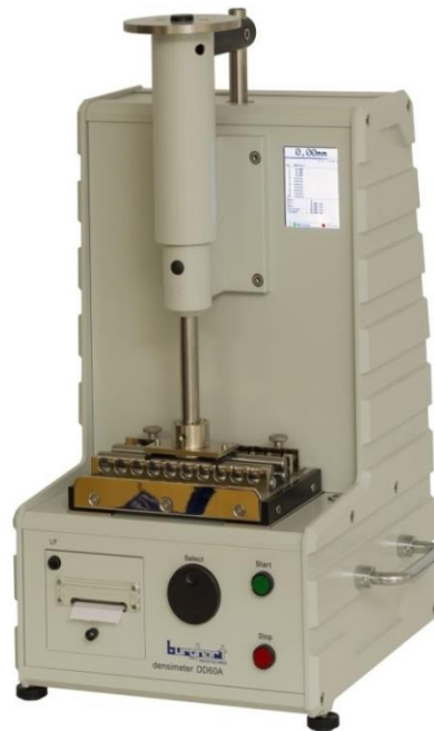
DD60A zur Härtemessung von Zigaretten oder Filterstäben
